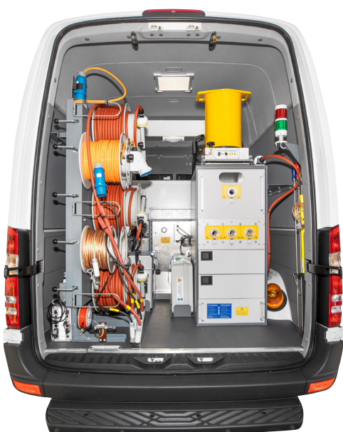
Příklad integrace do kabelového měřicího vozu
