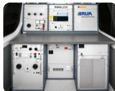
↑ 04 / Kabelový měřicí vůz transcable
