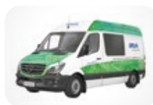
04 / Kabelový měřicí vůz transcable
